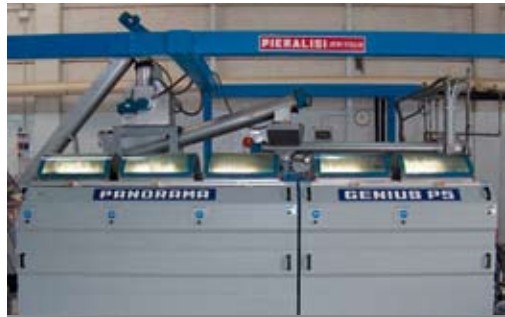
La centrifuga sustituye al proceso de prensado para separar el aceite de otros productos, sin necesidad de calentar ni de añadir productos químicos.
