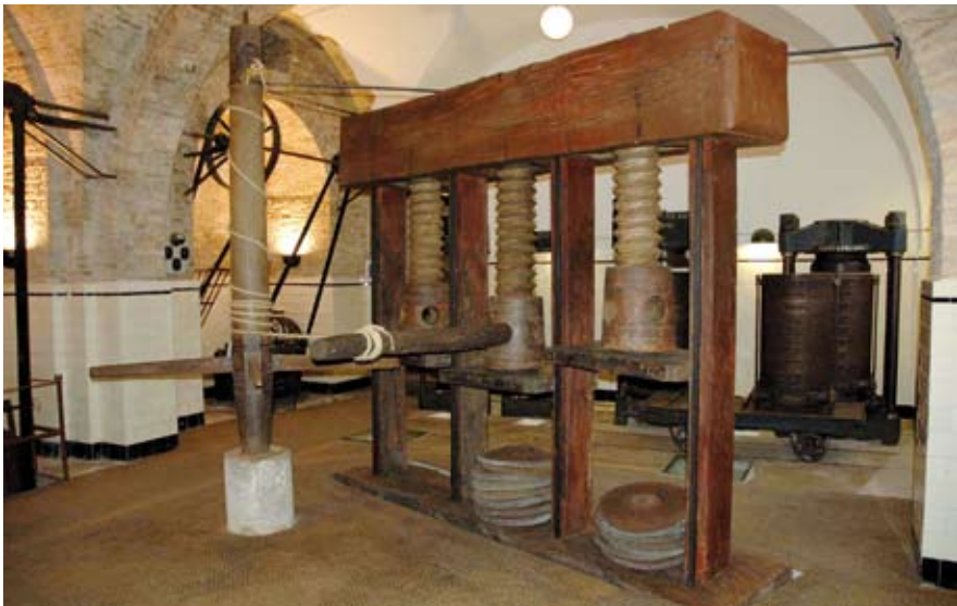
Figura 2: Prensa con tres tornillos sin fin (fabricados en madera de olmo).
